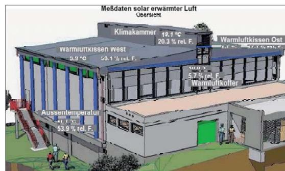
Bild 22 | Aufnahmebeispiel vom 28. Februar 2005, 15:47 Uhr: +31,1°C, Differenz zw. mittl. Koffer- u. Außentemp., Bewölk.: 1/8
