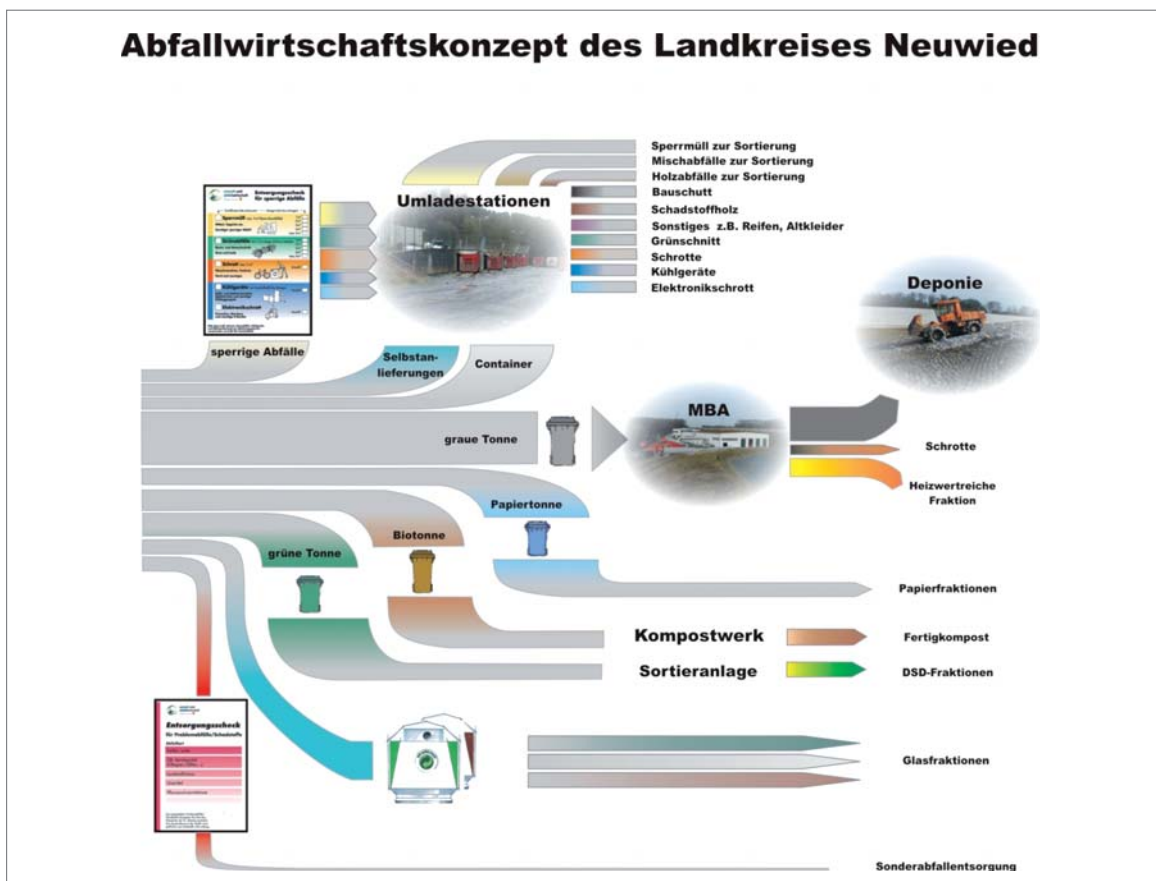
Abb. 1 | Schematische Darstellung des Abfall-Stoffstromes im Landkreis Neuwied
